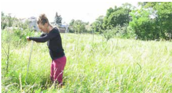
Le sondage d'une toubière est réalisé à l'aide d'une tarière,
