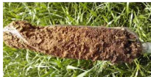
Le sondage d'une toubière est réalisé à l'aide d'une tarière,
